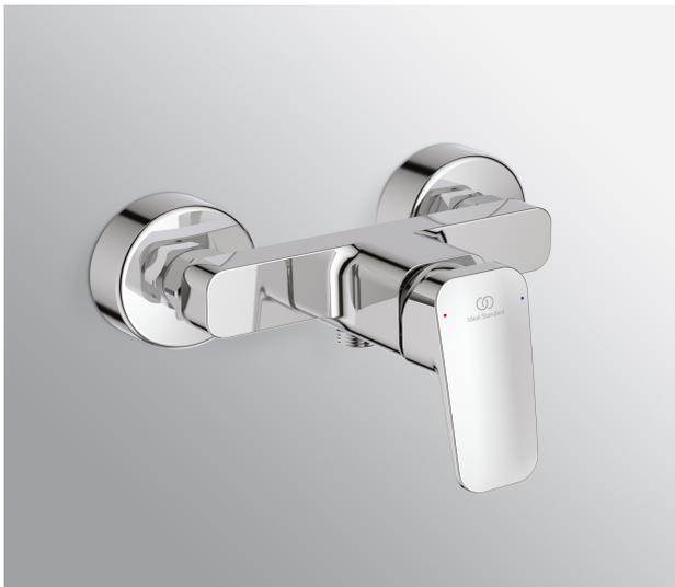
Miscelatore esterno per doccia con raccordi ad S da 1/2" regolabile per interasse da 150±23 mm. Cartuccia da 38 mm con sistema EKO. Non è corredato di componenti doccia.
