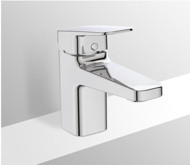
Miscelatore monocomando per lavabo con bocca di erogazione fissa e aeratore M24x1, asta di comando dello scarico, piletta da 1-1/4". Cartuccia da 38 mm con sistema EKO. Altezza bocca di erogazione 73 mm. Con aeratore 5 l/min ed Easy Fix.
