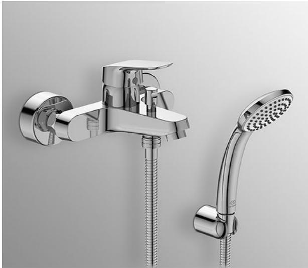
dotato di bocca di erogazione fissa e deviatore. Raccordi ad S da 1/2", regolabili per interasse da 150±23 mm. Cartuccia FirmaFlow® da 38 mm con sistema EKO. Corredato di doccetta ad 1 funzione con Ø80 mm, supporto fisso a muro e flessibile da 1500 mm.
