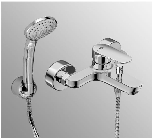
Miscelatore monocomando esterno per vasca/doccia. È dotato di raccordi ad S orientabili per interasse da 137 mm a 163 mm, limitatore della temperatura. È corredato da doccetta a 1 funzione, supporto a muro e tubo flessibile da 1500 mm.
