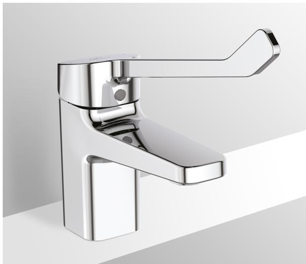
Miscelatore monocomando per lavabo a leva lunga con bocca di erogazione fissa e aeratore con portata massima 5 l/m, asta di comando dello scarico, piletta da 1-1/4", sistema di fissaggio Easy Fix. Cartuccia da 38 mm con limitatore della temperatura. Altezza della bocca di erogazione 73 mm.
