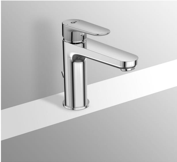
Miscelatore monocomando per lavabo con bocca di erogazione fissa ed aeratore slim M24x1 con portata massima 5 l/min, limitatore della temperatura, asta di comando dello scarico, piletta da 1-1/4". Sistema di fissaggio Easy Fix. Altezza bocca di erogazione 118 mm.
