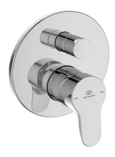
Completo di corpo ad incasso (Kit 1 + Kit 2). Con attacchi di alimentazione e scarico da 1/2". Cartuccia da 47 mm con sistema EKO. Non è corredato di componenti doccia.
